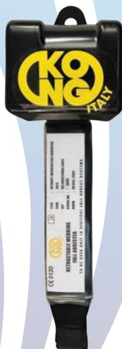
Anticaduta retrattile a richiamo automatico per utilizzo in verticale, con fettuccia in nylon da 47mm, lunghezza 2,5m. Assorbitore di energia incorporato per attutire gli urti in caso di caduta.
