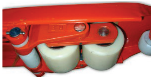
Ruote di guida e ruote di carico di Nylon, gomma o poliuretano
