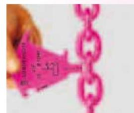
● Indicatore di sovratemperatura: Il rivestimento in polvere pink cambia colore con temperature superiori a 200 ° C. La catena non può essere utilizzata dopo essere stata esposta a temperature superiori a 400 ° C. A queste temperature il colore delle catene VIP diviene nero e presenta piccole bolle, chiara indicazione di sovrariscaldamento.
