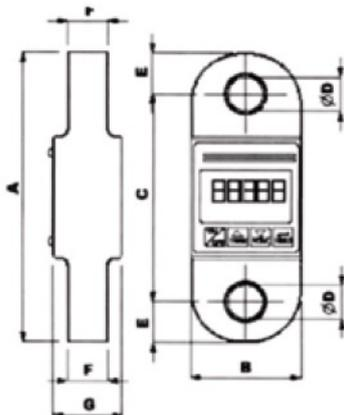
I dinamometri DEA sono apparecchi di elevata precisione per la misura di forze statiche di trazione e dei carichi statici.
