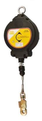
Anticaduta retrattile verticale a richiamo automatico, permette all'operatore un'elevata libertà di movimento durante il lavoro su ponteggi, tralicci e strutture tubolari. Dotato di guscio ultra-resistente in ABS, cavo metallico asolato con redancia e connettore a doppia leva di sicurezza con girello anti-attorciglamento.
