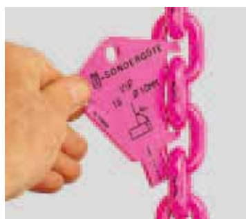
Controllo allungamento per sovraccarico
