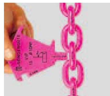
Controllo allungamento della dimensione nominale del passo per usura
